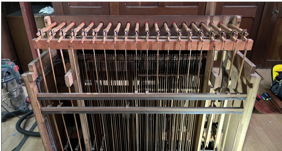
Achterzijde klavier met bovenaan de registerkeuze.
